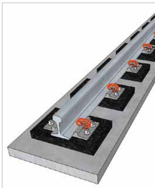
Kotvenie a zalievanie základov koľají pre žeriavy
